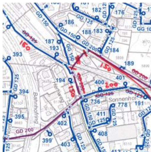
Abbildung 8, Vorschlag Massnahme Schaffhauserstrasse, Gossweiler Ingenieure AG, 2019
