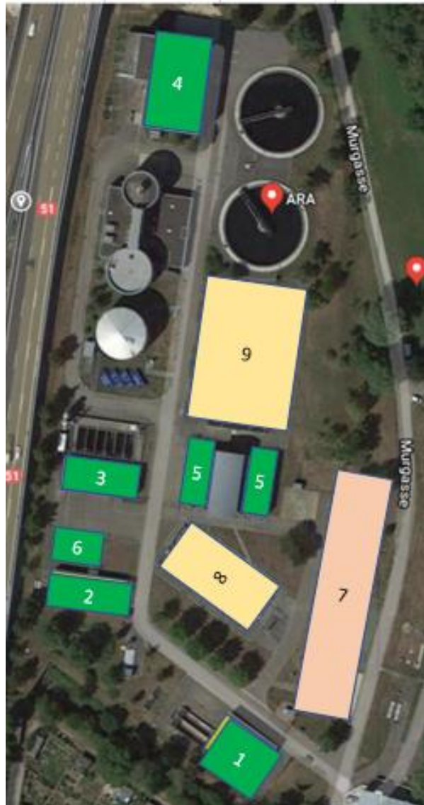
Abbildung 2: In Frage kommende Flächen für PV-Anlagen auf der ARA Furt aus dem Bericht der BGG Engineering AG
