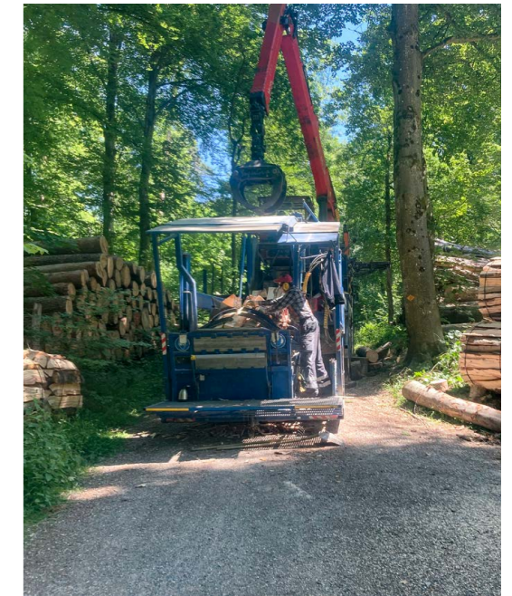
57 Der Brennholz-Spalter im Einsatz
