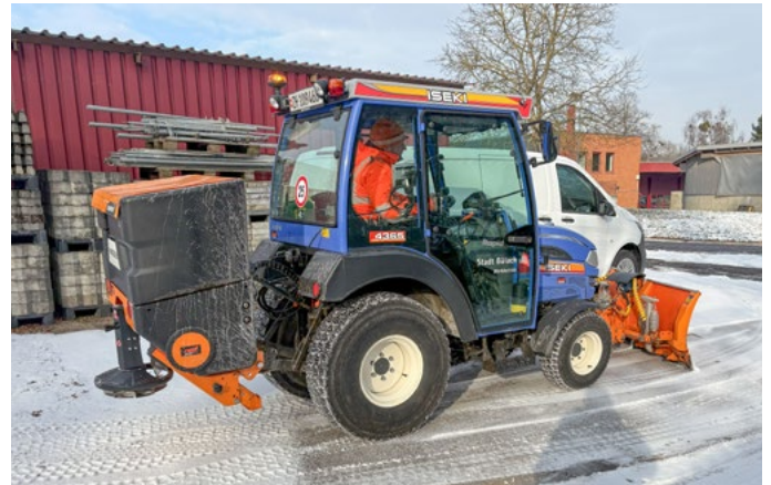
74 Einer der Iseki-Kleintraktoren mit neuem Salzstreuer
