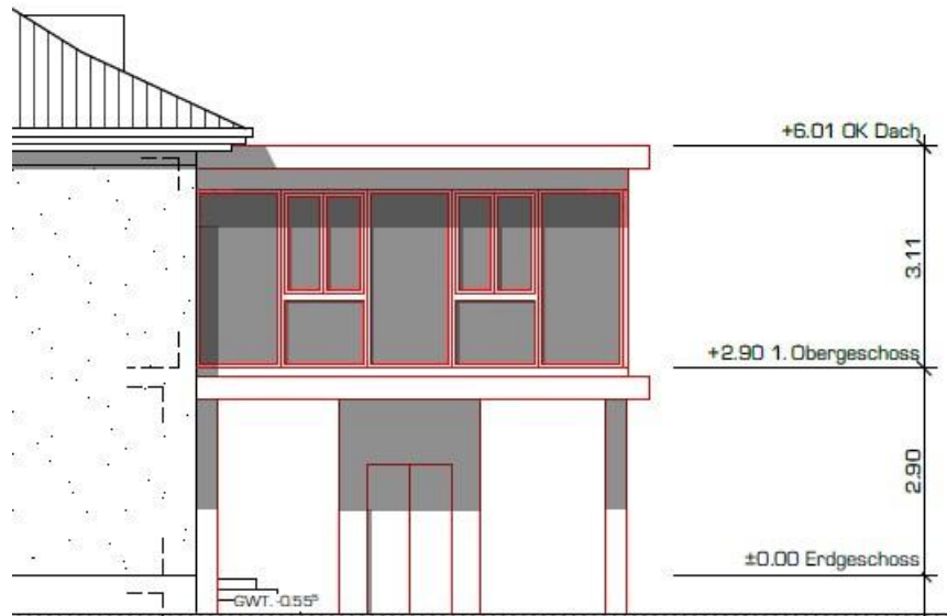
Nordfassade Erweiterung Teamzimmer
