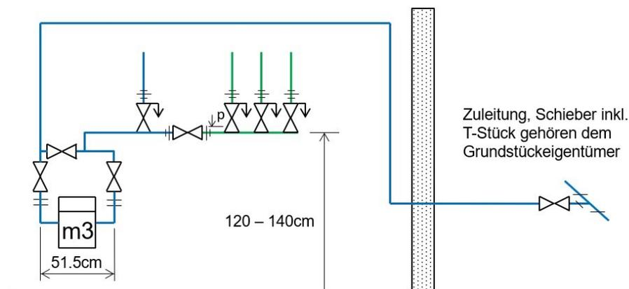
Wasserzähler können in der Wasserversorgung abgeholt werden, Montage bauseits.
