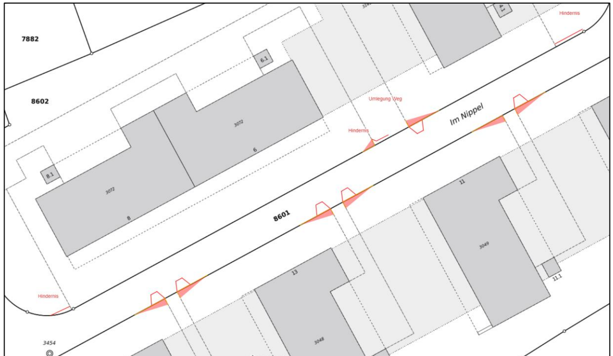
Abbildung 3: Bauliche Massnahmen zur Umsetzung von Tempo 30: Seitliche Einengungen und Anpassung Bepflanzungen.
