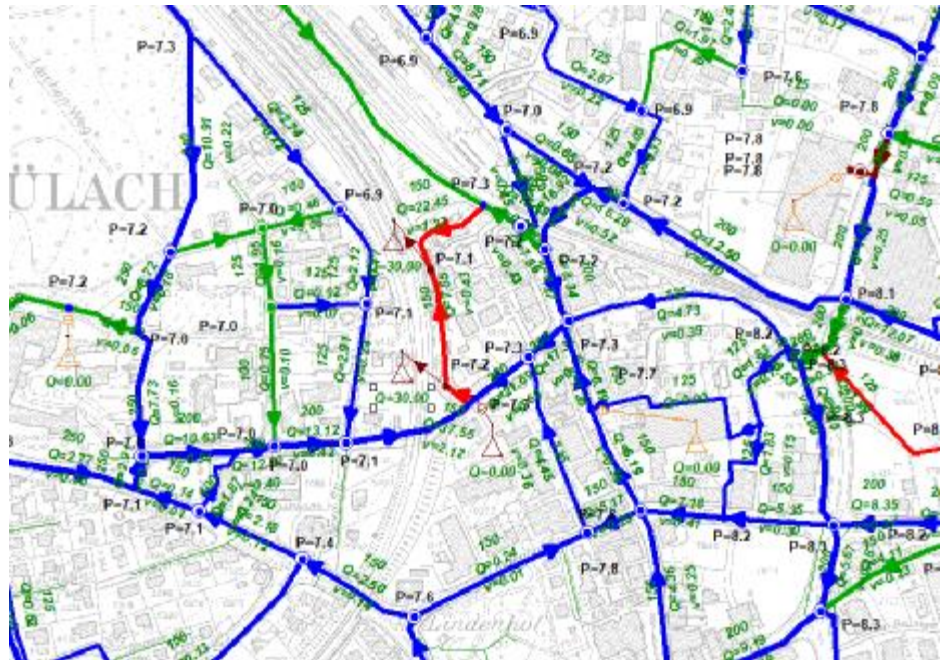
Abbildung 7, Druckverhältnisse Brandfall, je Hydrant 30 l/s = 2 x 1'800 l/min = 3'600 l/min
