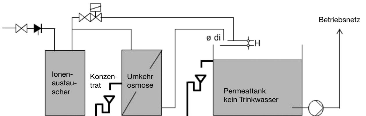
H = Abstand zwischen Wasseraustritt und höchstmöglichem Wasserspiegel
