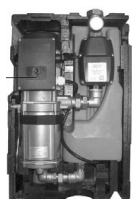
Abb. 8 Beispiel einer Kompakt-Trennstation nach SN EN 1717 – H 580 mm, B 380 mm, T 274 mm Aus Platzgründen ist der Flüssigkeitsbehälter lediglich mit dem rechteckigen Sicherheitsüberlauf ausgestattet.
