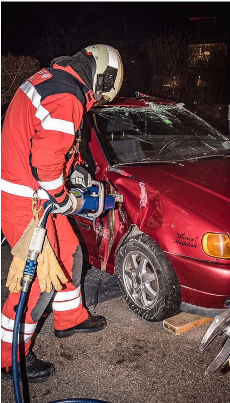
17 Angehörige der Feuerwehr trainieren mit Hydraulischem Rettungsgerät.
